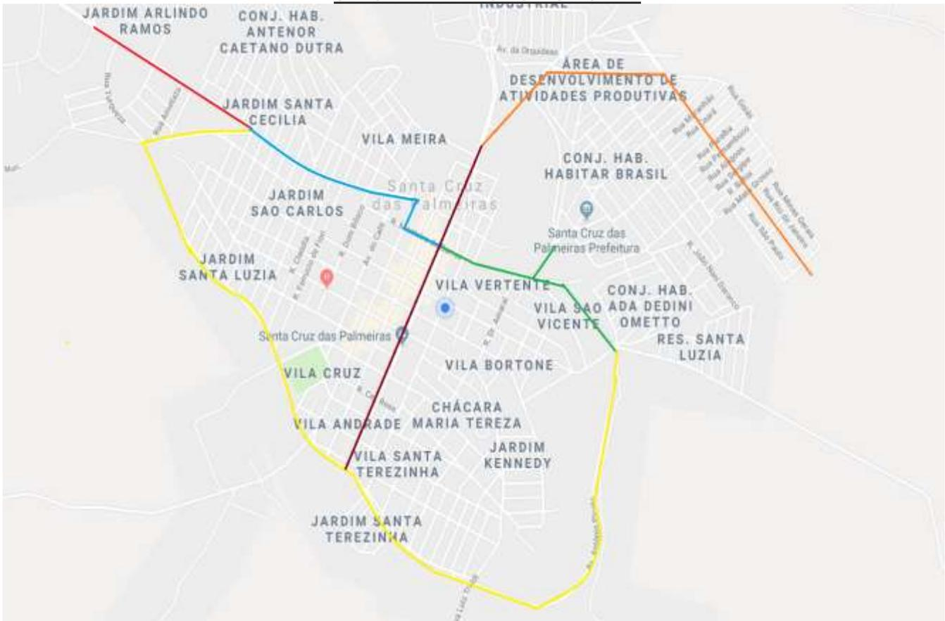
Imagem 8 – Sistema Ciclovitário: Detalhe das 5 etapas e do trecho já existente.
