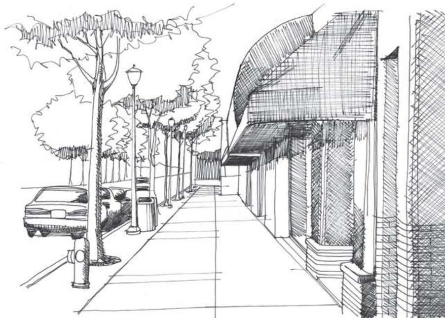
Figura 1 – Faixas que compõem uma calçada: instalação de serviços, livre circulação dos pedestres e acesso às edificações.
